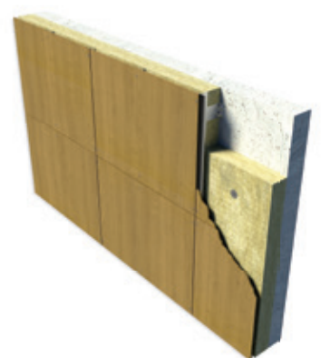
Bevestiging met blindklinknagels op een aluminium of stalen achterconstructie
