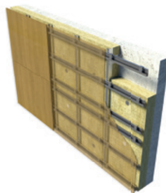
Blinde mechanische bevestiging op aluminium of stalen achterconstructie
